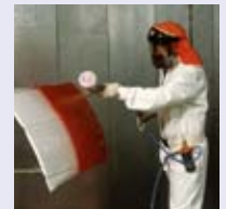
Farbspritzen Profi 200-280 l/min, 2-5 bar
