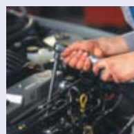
Ratschen- schrauber 200 l/min, 6-7 bar
