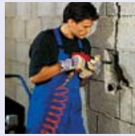
Abbruchhammer klein 156 l/min, 6-7 bar
