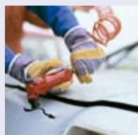
Blechknabber 150 l/min, 6-7 bar
