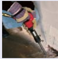
Abbruchhammer mittel 290 l/min, 6-7 bar
