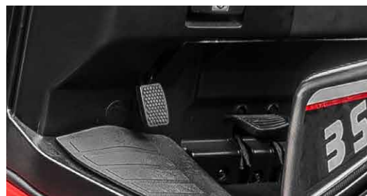
Pedalbediente Feststellbremse auf Wunsch
